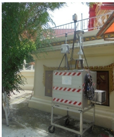
จุดตรวจวัดก๊าซมลพิษ CO SO 2 NO 2 และ HC ตรวจวัดฝุ่นละออง เสียงและแรงสั่นสะเทือน; วัดรบกวนสุขภาพ
